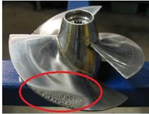
Figura 9: Daño por cavitación de un propulsor de una bomba axial
