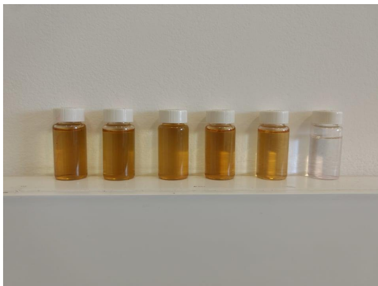
Figura 9: Soluciones de CIP 100mg/L irradiadas a dosis crecientes.
