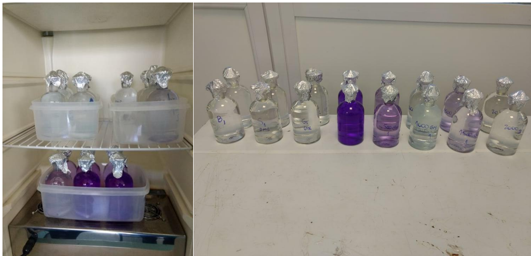
Figura 21: Frascos de Winkler con las distintas soluciones para determinar su DBO.
