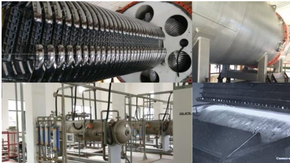
Figura 7. Tecnología e-beam utilizada para irradiar agua residual de industria textil. Fuente: (Miklos, 2017)
