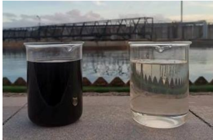
Figura 9. Muestras de los efluentes industriales textiles pre y post tratamiento. Fuente: (Willis, 2020)
