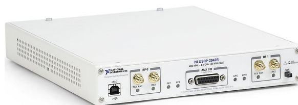
Figura 5.2: Imagen del USRP 2953 de la empresa National Instruments, dispositivo SDR empleado para la adquisición de los datos.
