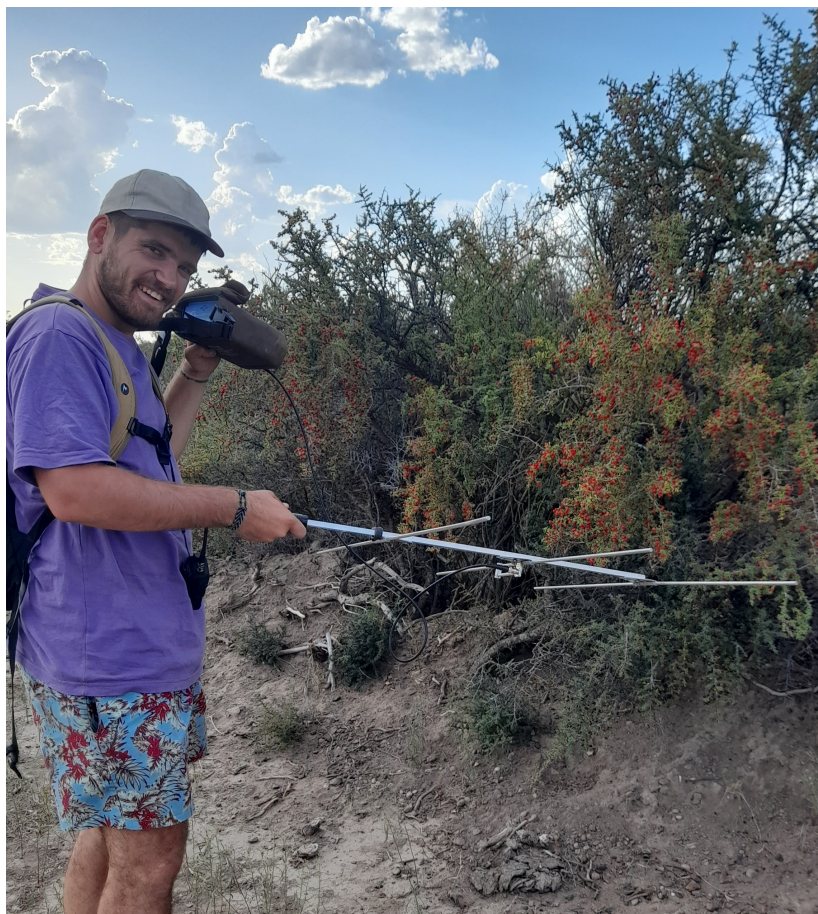
Figura 1.4: Antena Yagui-Uda conectada a un receptor ATS R410 (Advanced Telemetry Systems). En la imagen se está buscando localizar la posición de una tortuga que contiene un radiotransmisor en su caparazón (Fig. 1.3).
