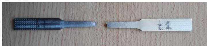
*Figura 7: Probeta después el ensayo de tracción*
