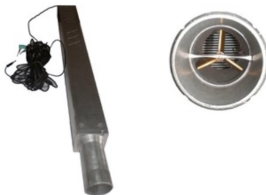
Figura 3.1: Composición de sistemas del dummy caudalímetro.
