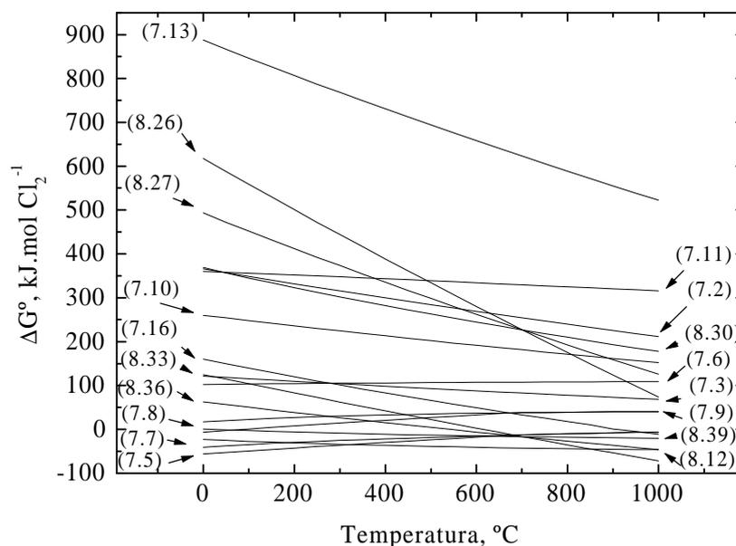
Figura 8.1: Diagrama de Ellingham. Reacciones en el sistema  $\text{Sm}_2\text{O}_3(s)\text{-Cl}_2(g)\text{-C}(s)$  con  $\Delta G^0 > -100 \text{ kJ.mol}^{-1}$  entre TA y  $950 \text{ }^\circ\text{C}$ .
