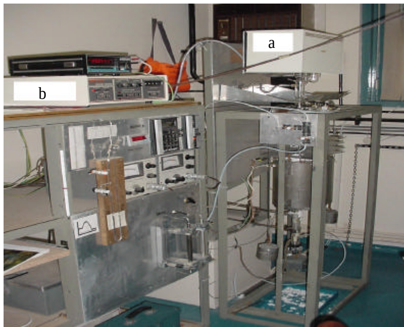
Figura 3.1: Sistema termogravimétrico. a) Cabezal. b) Unidad de control.
