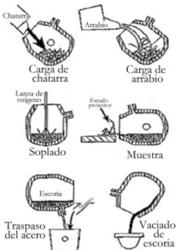
Figura 1. Etapas de producción del acero con un convertidor BOF. Ref. [1]
