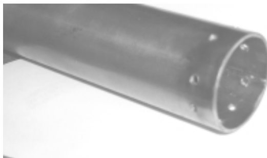
Figura 20. Caño metálico para alojar el cerámico. Nótese los agujeros de salida del aire refrigerante.
