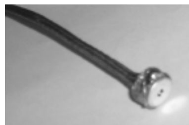
Figura 21. Micrófono utilizado. Nótese la malla de blindaje.
