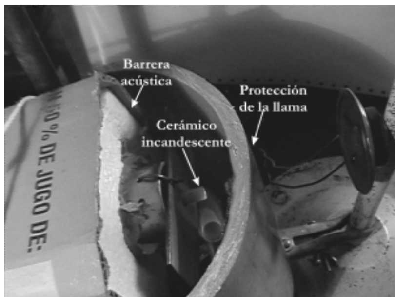
Figura 24. Fotografía del dispositivo experimental. Nótese el extremo del cerámico incandescente y la protección para estabilizar la llama.
