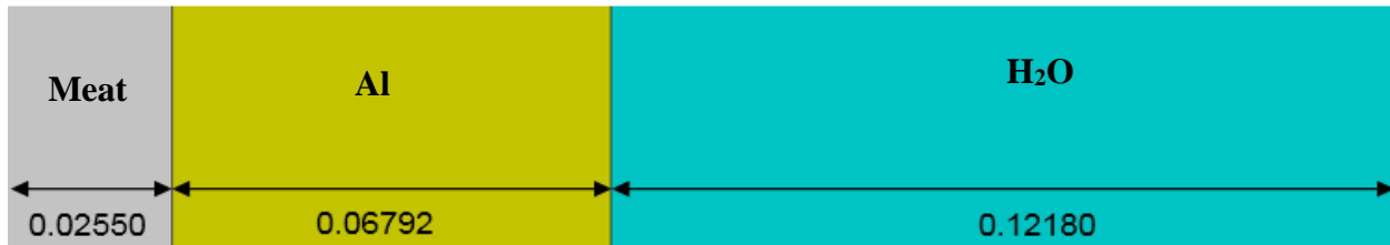
Fig. A.5: Modelo 1D de conservación del meat de ECN (dimensiones en cm)
