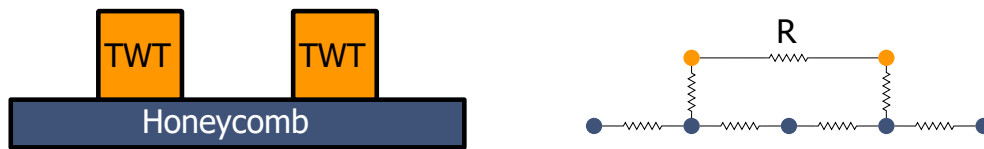
Figura 3.2: Posible discretización de dos tubos amplificadores y la superficie donde están montados. La R identifica la relación de radiatividad entre nodos que no tienen un camino de conducción entre ellos.
