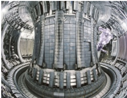
(b) Vista interior de la cámara de vacío de un tokamak.
