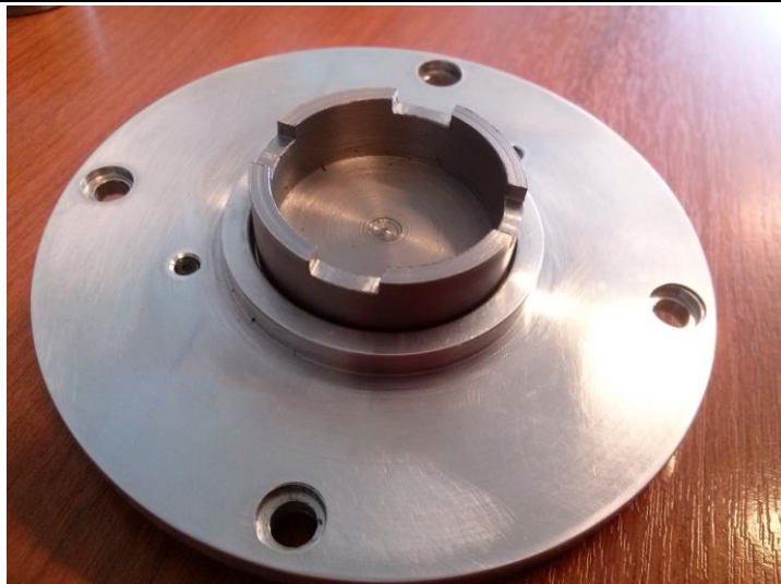
Figura 3: Imagen de platina con portamuestras bajo, montado sobre la base de aluminio.
