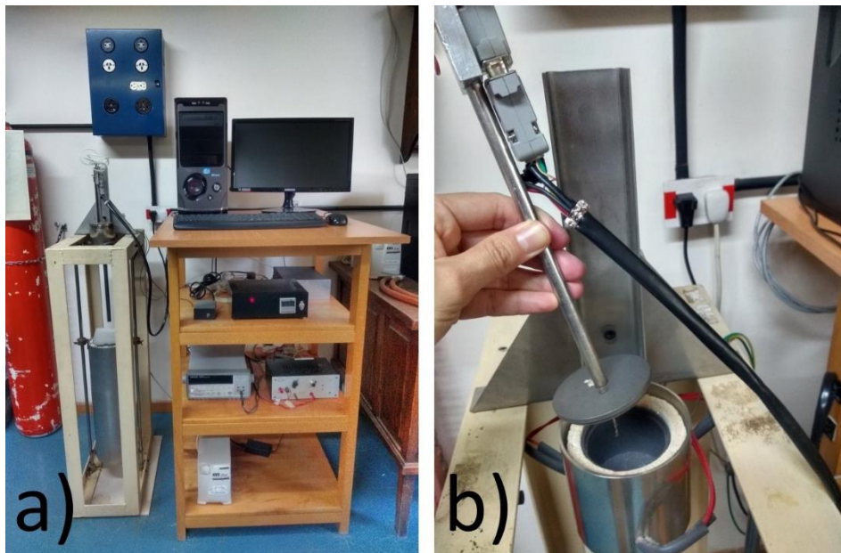
Figura 2-9. a) Equipo de resistividad eléctrica, b) Detalle del crióstato y el portamuestras.
