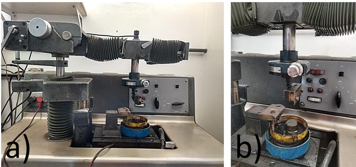
Figura 2-4. a) Máquina de electro-erosión, b) Detalle del portamuestras y el portaelectrodo.
