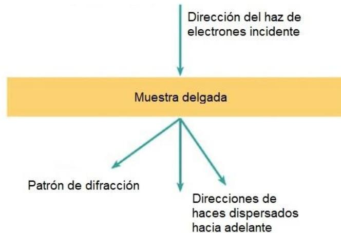
**Figura 2.7** Interacción con la muestra y señales producidas.
