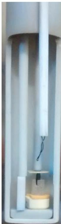
**Figura 6.1** Medición dilatométrica en la dirección vertical (observar que la muestra -oscura- se encuentra ubicada sobre la ranura del soporte de alúmina).
